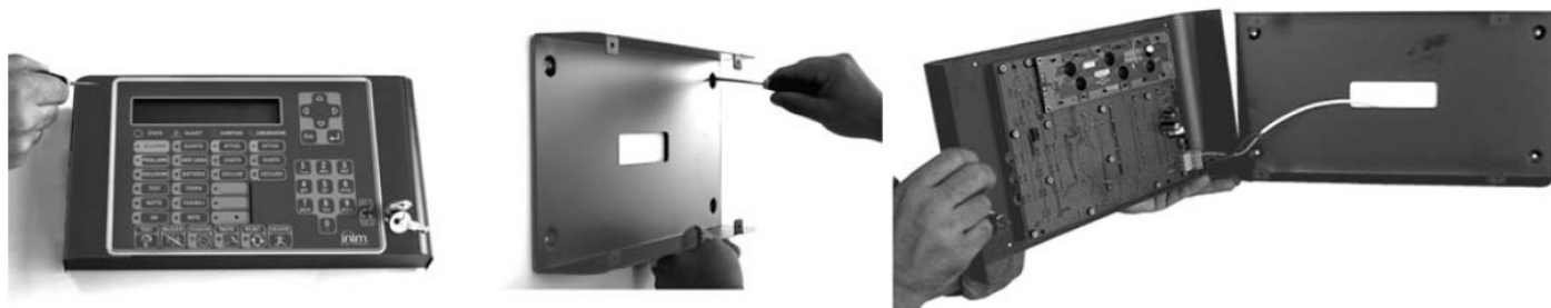
Rysunek 13 - Montaż terminala wyniesionego
