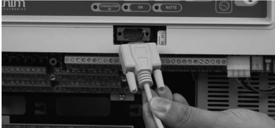
Rysunek 38 - Podłączenie złącza RS232
